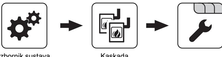
Za prioritete kotla postavlja se redoslijed prema kojem se pokreću kotlovi. Kod kotlova s istim prioritetom uvijek se pokreće kotao s trenutačno najmanjim brojem radnih sati.
