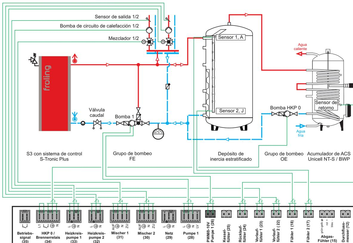
Seleccione el sistema «Sistema hidráulico para S-Tronic».
