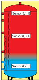
Si, además de los dos sensores incluidos de manera predeterminada en el depósito de inercia, se utiliza también un sensor adicional en el centro del depósito de inercia (p. ej., cálculo de las cantidades de reposición, criterio de desconexión de la unidad de pellets de una caldera combinada, etc.), es preciso activar este parámetro.
