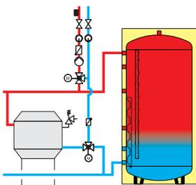
Si existe una válvula de conmutación en el retorno de la caldera secundaria en combinación con una caldera secundaria, es preciso activar este parámetro.
