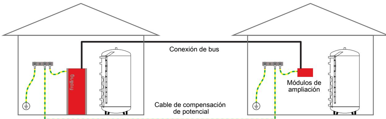
**NOTA** El dimensionamiento del cable de compensación debe correr a cargo de un técnico especializado que actúe según las disposiciones regionales.
