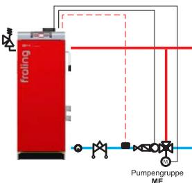
Si la elevación del retorno se ejecuta mediante un mezclador y el control se realiza en el módulo principal a través del circuito de calefacción 1, es preciso activar este parámetro.
