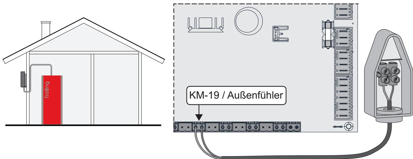
En el estado original de fábrica, el sensor exterior es leído por el módulo principal (conexión «KM-19/sensor exterior»). El sensor exterior también puede conectarse a un módulo de circuito de calefacción adicional.
