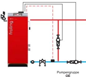
Si la elevación del retorno se ejecuta mediante la bomba de derivación, es preciso activar este parámetro.
