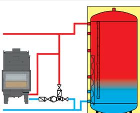
Si se encuentra disponible un generador de calor adicional (p. ej., horno de chimenea con depósito de agua) que deba incorporarse en el sistema hidráulico a través del control de la caldera de Froling, es preciso activar este parámetro.
