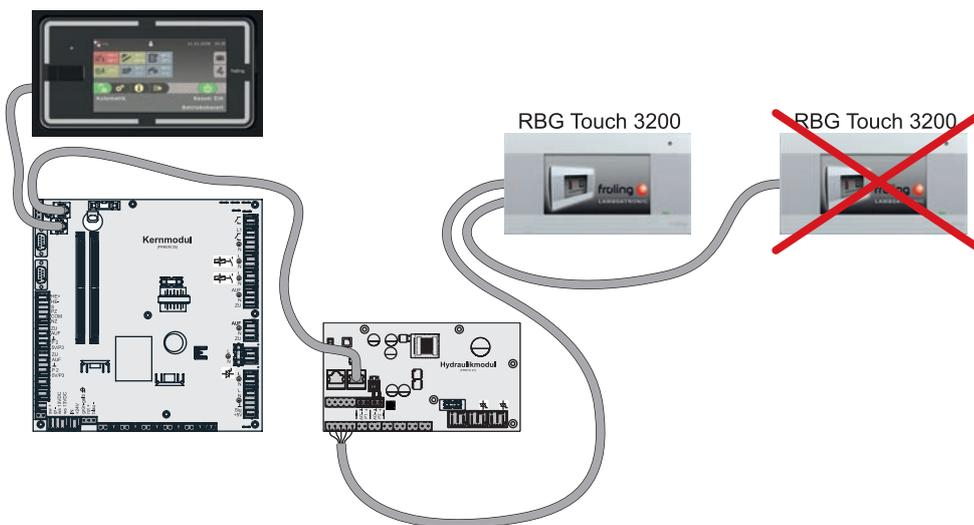
Para cada panel de control táctil, debe utilizarse un módulo de alimentación (módulo de circuito de calefacción, módulo hidráulico).
