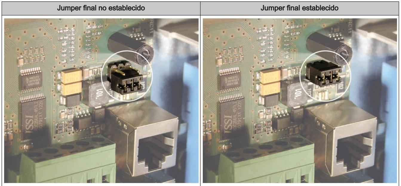
Si los contactos del zócalo del jumper final no están puenteados (figura izquierda), se habla de «no establecido». En este caso, el cierre del bus no está realizado. Si los contactos están cerrados (figura derecha), el jumper final está establecido y el cierre de la conexión del bus está realizado.
