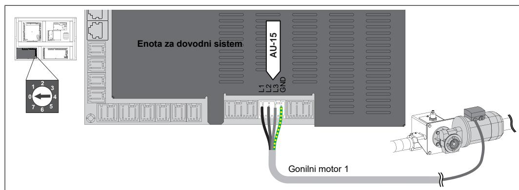
Gonilni motor sesalnega polža pelet 1 priključite na enoto za dovodni sistem (naslov 0) na regulaciji kotla
