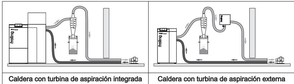
El ciclón de separación de polvo se incorpora en el **conducto de aire de retorno** del sistema de aspiración de pellets, donde se separan las partículas de polvo contenidas en el aire de retorno. La posición del colector de polvo en el conducto de aire de retorno puede seleccionarse libremente.
