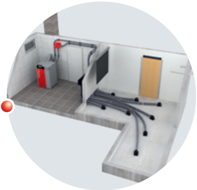
Pellets-Saugsystem RS 4 / RS 8 Mit automatischer Rückspülung
