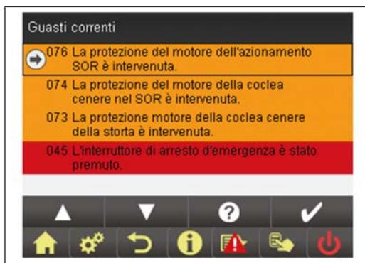
Il termine "guasto" è un termine generico che riunisce i concetti di avvertenza, errore o allarme. I tre tipi di messaggi si differenziano nel comportamento della caldaia:
