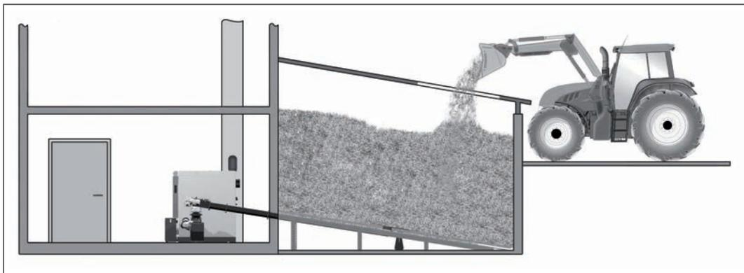
Se il deposito contiene ancora una quantità sufficiente di combustibile (testa dell'estrattore completamente coperta di combustibile e bracci dell'estrattore / bracci a molle non estesi), è possibile riempire il deposito.
