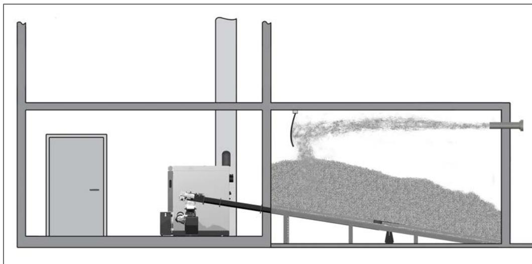
Se il deposito contiene ancora una quantità sufficiente di combustibile (testa dell'estrattore completamente coperta di combustibile e bracci dell'estrattore / bracci a molle non estesi), è possibile riempire il deposito nel modo seguente.
