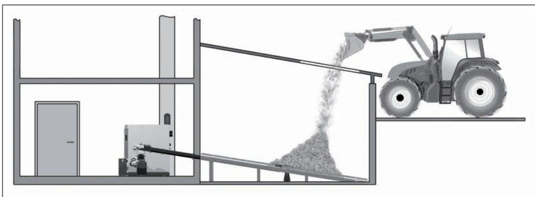
Se la testa dell'estrattore è già priva di materiale e i bracci dell'estrattore / i bracci a molle sono sollevati, il dispositivo di trasporto deve essere attivo fino a quando i bracci dell'estrattore / i bracci a molle sono completamente ritratti.
