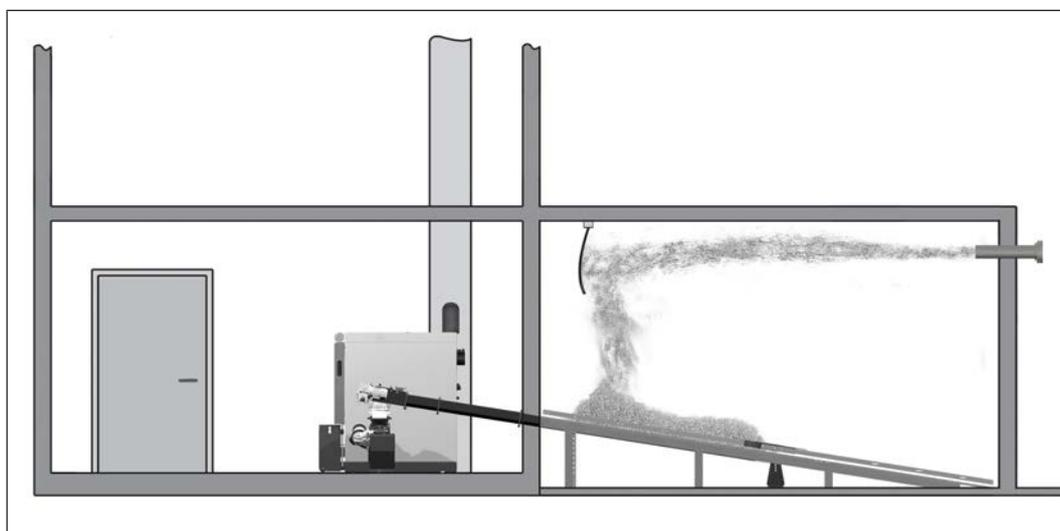
Se la testa dell'estrattore è già priva di materiale e i bracci dell'estrattore / bracci a molle sono sollevati, questi ultimi devono essere coperti con il combustibile residuo presente nel deposito e ritratti. Terminare questi lavori in tempo utile prima della data di riempimento concordata.
