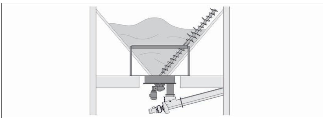
Se la coclea inclinata è ancora coperta di combustibile e si trova ancora in posizione verticale, il deposito può essere riempito.
