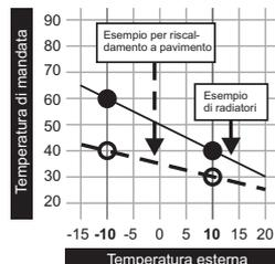
Tramite la curva di riscaldamento del circuito di riscaldamento, in base alla temperatura esterna, viene calcolata una temperatura di mandata con due parametri impostabili “Temperatura mandata con temperatura esterna  $-10^{\circ}\text{C}$ ” e “Temperatura mandata con temperatura esterna  $+10^{\circ}\text{C}$ ”.
