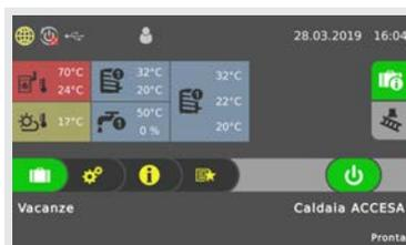
Al raggiungimento della data di inizio impostata del programma vacanze, la caldaia passa al modo operativo "Vacanze"
