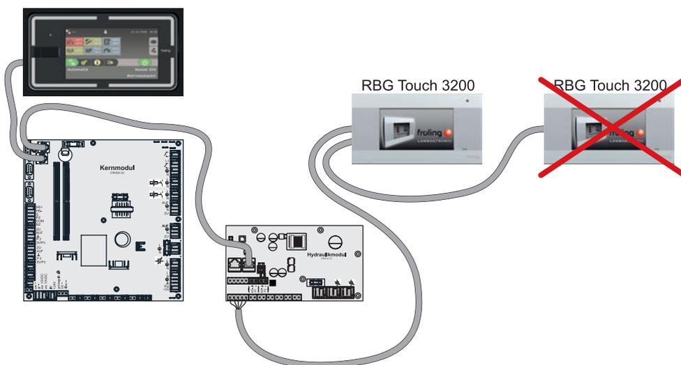
Pour chaque tableau de commande tactile, un module d'alimentation électrique (module de circuit de chauffage, module hydraulique) doit être utilisé.
