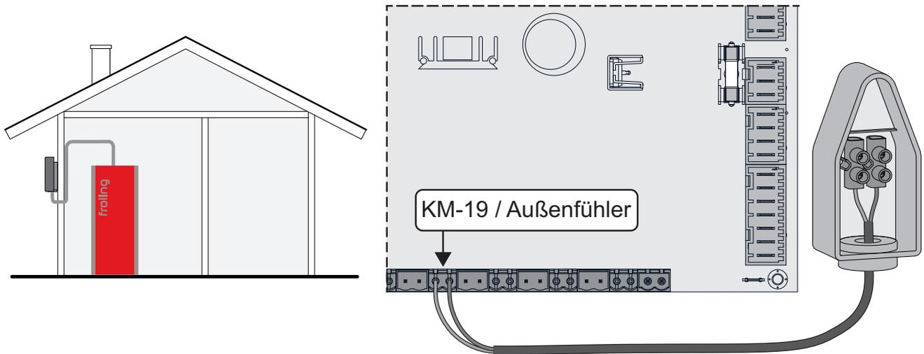
À la livraison, la sonde extérieure est lue par le module principal (raccordement « KM-19 / sonde extérieure »). Alternativement, la sonde extérieure peut être reliée à un module de circuit de chauffage additionnel.
